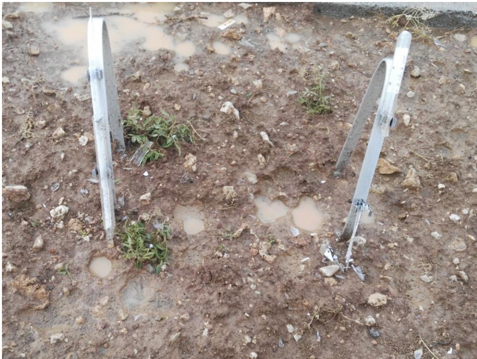
شکسته شدن دماسنج اعماق خاک در اثر بارش تگرگ و آثار ناشی از برخورد تگرگ با سطح زمین
